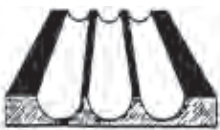
El escopleo con arco elimina irregularidades de superficies endurecidas por el trabajo y grietas
