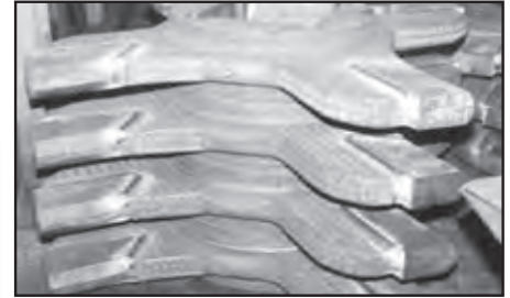
Rompedor de sinterizado revestido con 2834-MCO
