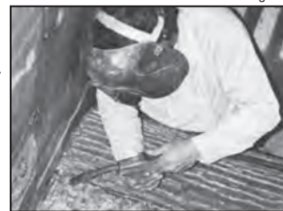
Rodillo de trituración con superficie endurecida con 2820-MCO después de la aplicación de Postalloy 2865-FCO
