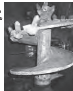
Tornillo sinfín revestido con 2832-MCO
