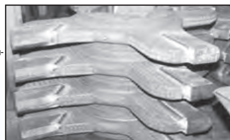
Rompedor de sinterizado revestido con 2834-MCO
