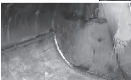
Pala fabricada con 3044-FCG.
